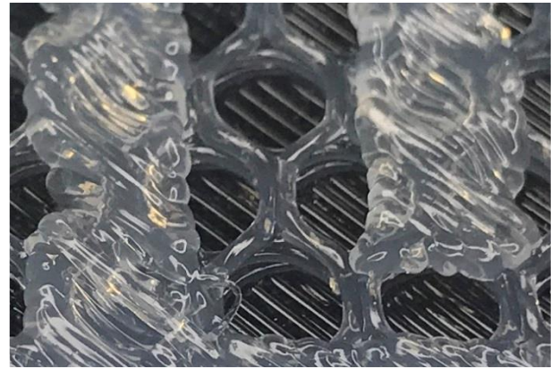
الشكل 3: نمط قرص العسل من السيليكون يظهر طبقة انكماش ملحوظة بالخطوط.
