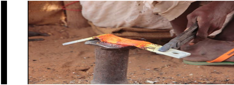
صورة رقم 8 جانب من تشكيل قطعة حديد خام
