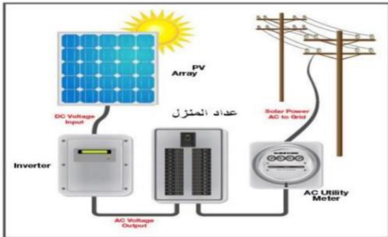
يعمل هذا النوع من العواكس كنظام منظم شحن مزلل وينتج تيار AC وينظم شحن البطاريات عندما تكون الشبكة الكهربائية هي المغذي للحمل وعندما تكون PV المغذي ينقل التيار الى الحمل.
