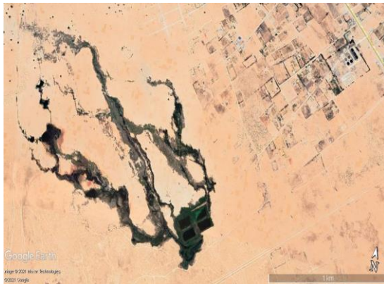
الشكل 1: موقع محطة الصرف الصحي شكل 2: تسرب مياه الصرف الصحي من المحطة باتجاه المدينة.
