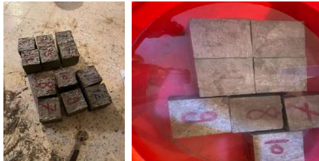
الشكل (8): العينات بعد فك القوالب ومجموعة المعالجة بالغمر في الماء.
