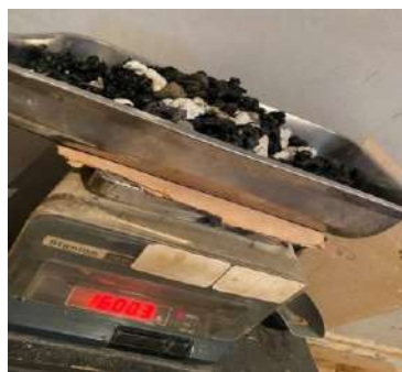
الشكل (4): تجهيز المخلفات المستخدمة مع الركام قبل الخلط.
