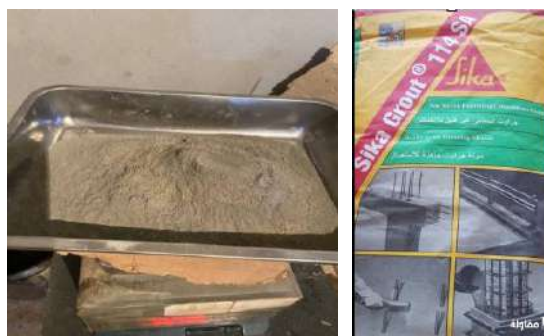
الشكل (5): المادة المسماة سيكا في الدراسة وعبوتها التجارية الظاهرة في الصور الأصلية.
