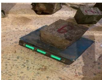
الشكل (10): وزن المكعب الخرساني باستخدام الميزان.
