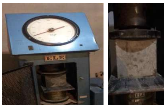
الشكل (9): جهاز اختبار الضغط ووضع المكعب بين لوحَي التحميل.
