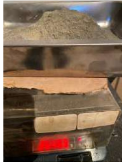
الشكل (1): وزن الأسمنت المستخدم في الخلطات الخرسانية.
