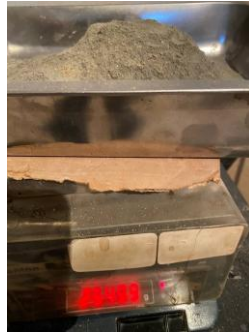
الشكل (1): وزن الأسمنت المستخدم في الخلطات الخرسانية.
