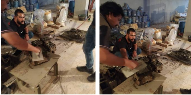
الشكل (7): صب الخلطة في القوالب المكعبة وتجهيز العينات.
