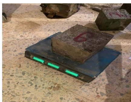
الشكل (10): وزن المكعب الخرساني باستخدام الميزان.
